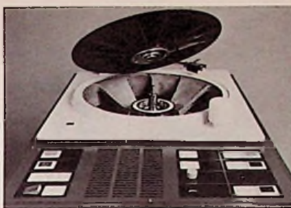
Bild 2. Leichter Plattenteller. Die Rippen an der Unterseite sorgen für die notwendige Festigkeit des Epoxyd-Tellers (33 cm Durchmesser). Im Unterteil ist auch der Bremsmagnet als doppelter Ring zu erkennen
