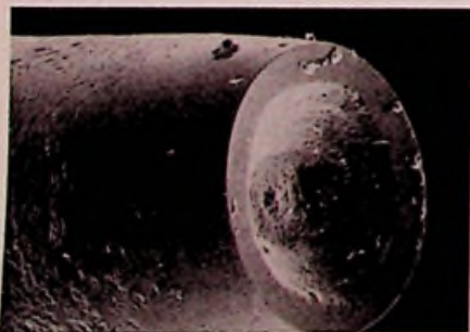
Bild 1. Edison-Schneidstichel aus Saphir (Institut für Photoanalyse, Hofgeismar)
