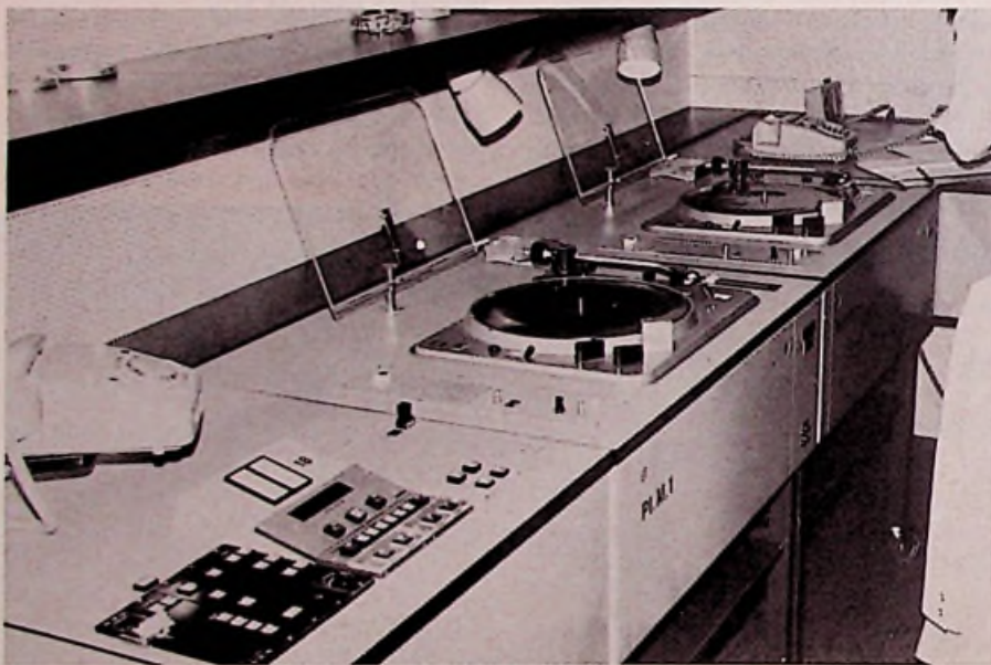
Bild 4. Zwei Studio-Plattenspieler in einem Rundfunk-Regieraum. Die Truhen enthalten auf ihrer linken Seite ein Lautsprecherfeld zum Vorabhören und zum Auffinden von Modulationsanfang oder Einsatzpunkt. Rechts vom Laufwerk-Chassis befindet sich jeweils ein Stereo-Steller zum Einblenden der Modulation. Die Plexi-Ablage nimmt den Sendeplan auf, oder dient als Ablage für Plattenhüllen
